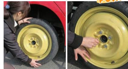
スペアタイヤを付けます。タイヤを押しながらすべてのナットを手で締め付け、レンチで仮締めします。
