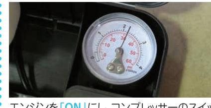
エンジンを「ON」にし、コンプレッサーのスイッチを「ON」にします。目盛りを見ながら適正な空気圧になるまで空気を入れます。
