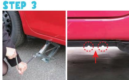
ジャッキ用補助工具を使用して、タイヤが少し浮くまでジャッキアップします。
