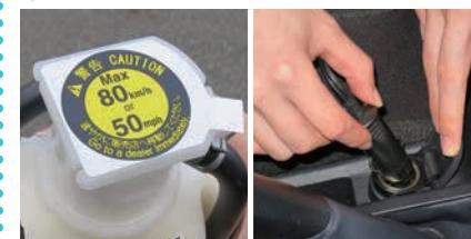
制限速度シールを運転席の目立つ場所に貼り、電源プラグをシガーソケットに差し込みます。
