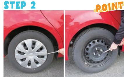
レンチの先を使ってホイールキャップを外し、レンチでタイヤのナットを反時計回りに回してゆります。ゆるめる量は半回転ほど。
