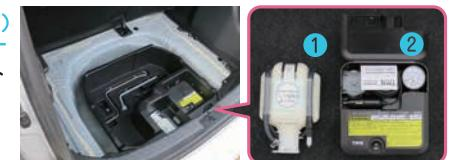
注意 パンク修理剤はトレッド部(接地部)にクギやネジが刺さるなどの軽度のパンクを応急処置するためのものです。抜いてしまうとタイヤパンク応急修理キットでの応急処置ができない場合がありますので注意しましょう。
